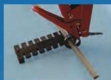
2. Закрепите кабели на панели с помощью кабельной стяжки.
