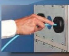
3. Провода без штекеров просто протолкните через предварительно проделанное отверстие в резине и протяните на нужную длину. Чтобы снять нагрузку, потяните кабель обратно.
