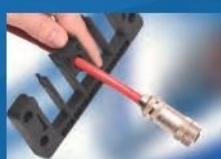
3. Вставьте наконечник с предварительно смонтированным кабелем в KDL/E. Можно вставить до 10 кабелей. При использовании двойных наконечников даже до 20 кабелей.
