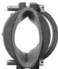
Рис. 1. Гайка с втулкой старого образца
